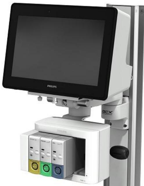
El Rack de mediciones Philips 6000 es un soporte auxiliar optativo para los monitores, que amplía las posibilidades de monitoreo a través de módulos específicos que se anexan a la capacidad intrínseca de cada monitor.
